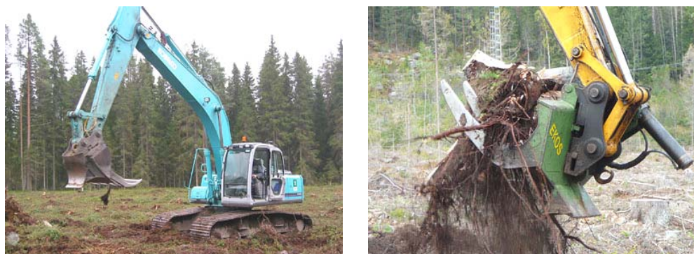
Figura 17. Escavadeira e cabeçote para remoção de toco e raízes.
