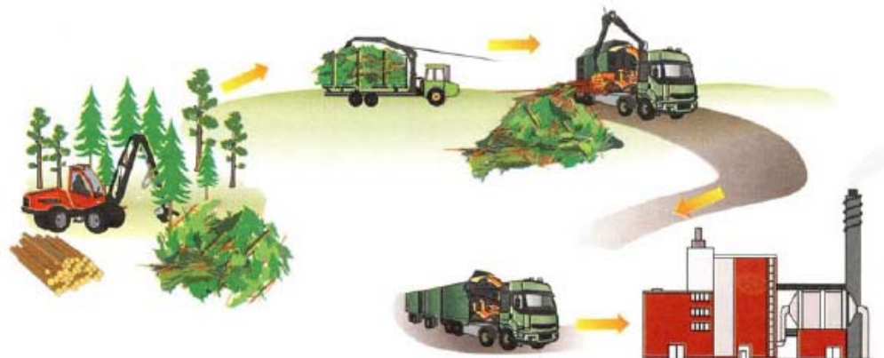
Figura 7. Sistema com cavaqueamento nas margens de estradas.
