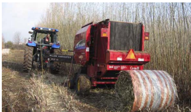
Figura 24. Enfardadora ( baling machine ) desenvolvida para colher e embalar Salix sp .
