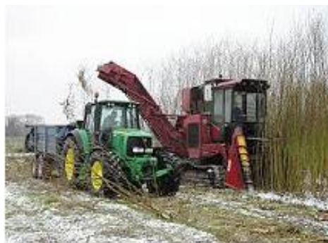
Figura 21. Colhedoras de corte contínuo do tipo cut-and-chip .
