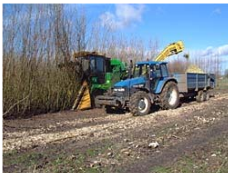
Figura 21. Colhedoras de corte contínuo do tipo cut-and-chip .
