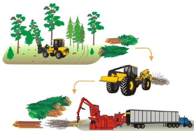
Figura 12. Sistema de árvores inteiras com cavaqueamento de biomassa residual.
