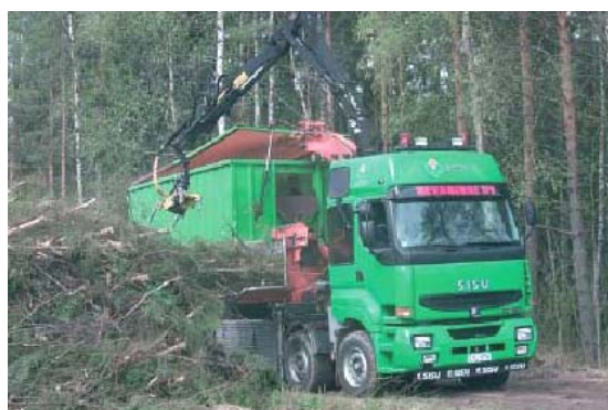
Figura 8. Caminhão com capacidade de realizar o cavaqueamento dos resíduos e o transporte dos cavacos até a planta energética ( Sisu Chipper ).
